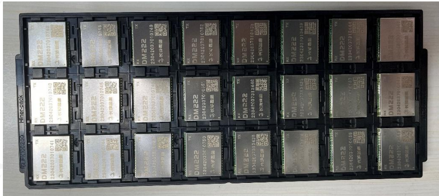
图 7 DM222 模块包装示意图
