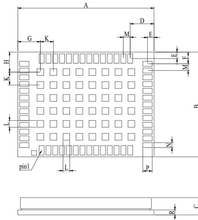
图 3 结构尺寸图
