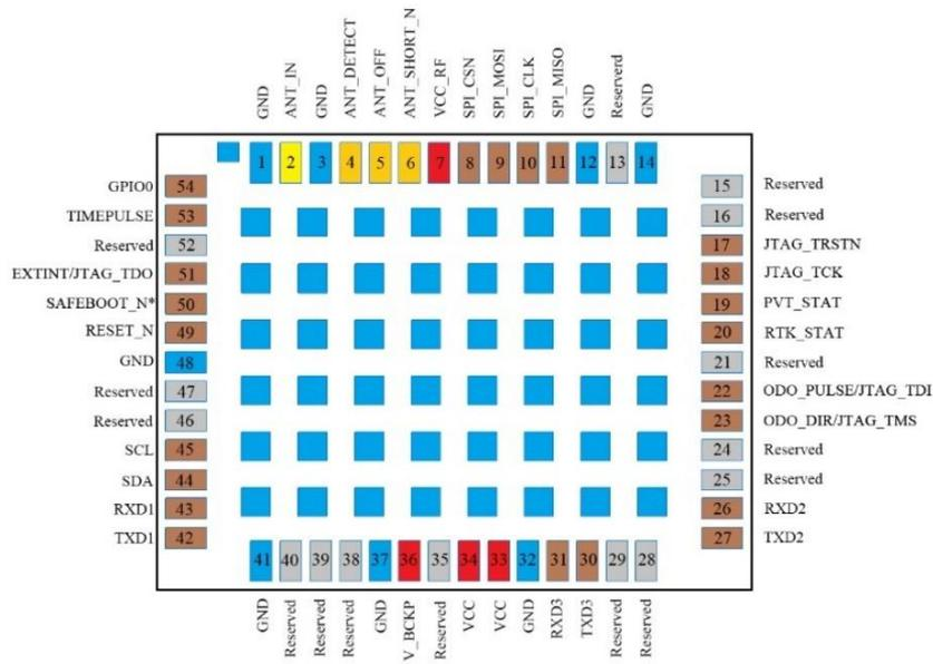
图 5 引脚定义图-Bottom View
