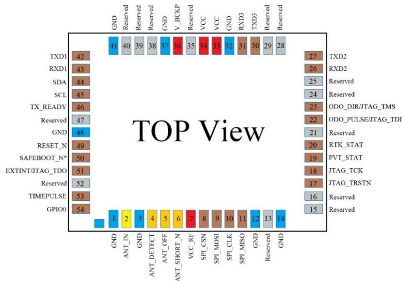
图 4 引脚定义图-TOP View
